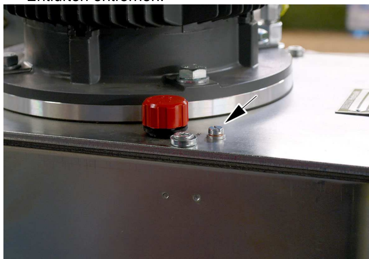
Bild 8.3: Entlüftungsschraube am Aggregat R
