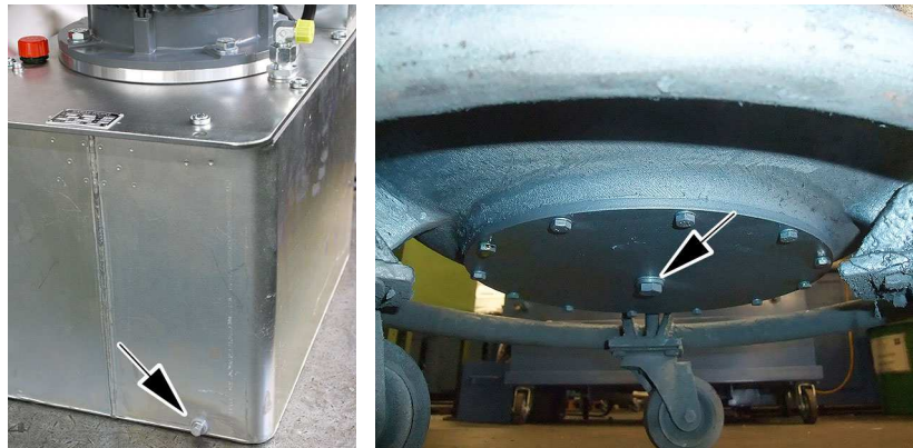
Bild 8.1: Ölablassschraube am Aggregat R (links) und T (rechts)
